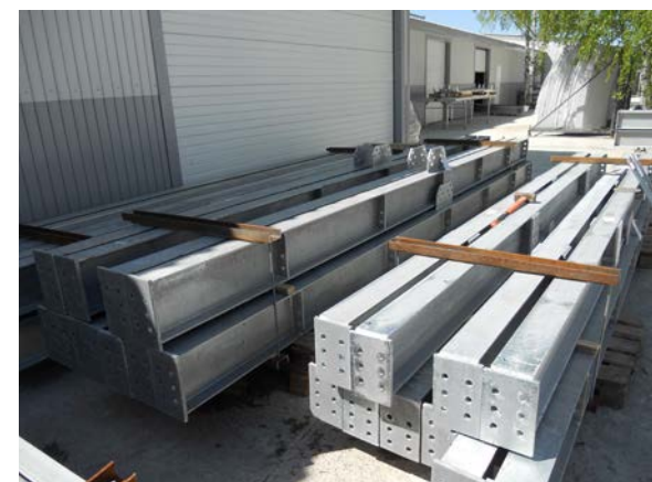
Металлоконструкции градирни СВГ
